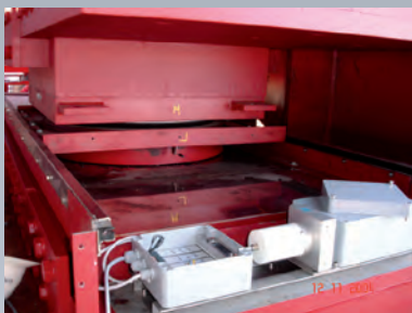
Monitoringsystem zur laufenden Online-Überwachung der Lagerverformungen der Tejo-Brücke "25. April" in Lissabon, Portugal
