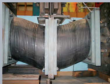
Dynamischer Schubversuch an MAURER Elastomer-Isolatoren aus eigener Fertigung und spezieller Rezeptur für eine Uranaufbereitungsanlage in Frankreich
