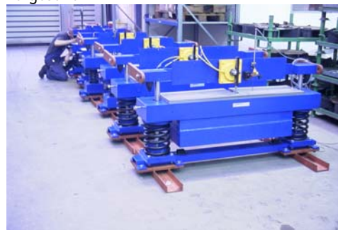
Bild 3 Die fertigen 6 Tilger in der Montagehalle
