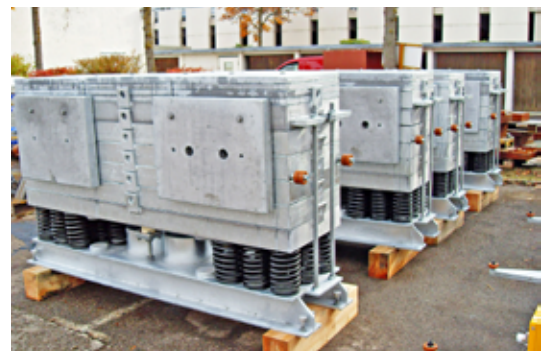
Die feuerverzinkten Massedämpfer mit einem Gewicht von 6.500 kg/Stück und einer Schwingfrequenz von 1,87 Hz vor dem Einbau in die Fußgängerbrücke zur Autostadt Wolfsburg.
